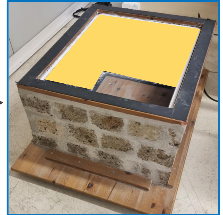
Materiale impermeabilizzante applicato sul supporto di cartongesso
