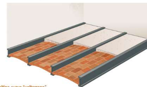
Voltine curve "volterrane".
