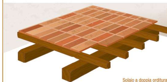
Solaio a doppia orditura con piastrelle in cotto.
