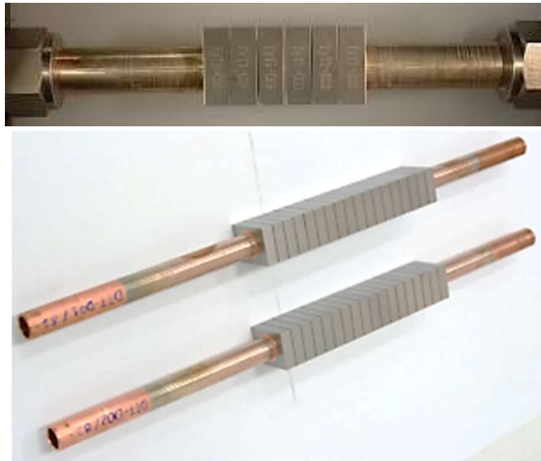
Campioni del target del divertore prodotti da ENEA Frascati
