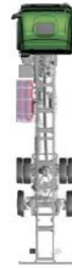
Serbatoi CNG lato sx
