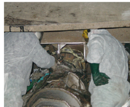
Operazioni di pulizia all'interno del trituttore
