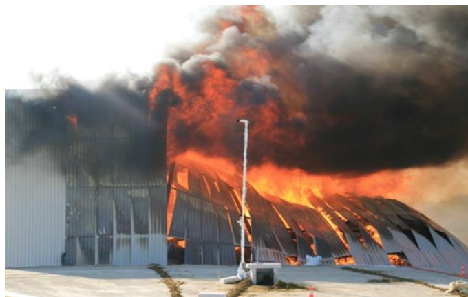
FLUMILOG, verifica sperimentale del comportamento delle strutture di acciaio di edifici industriali esposte all'incendio
