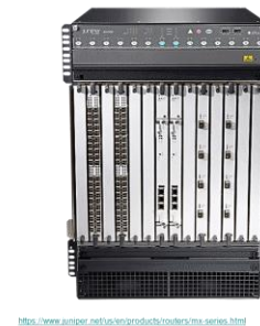
Juniper MX960 (anno 2006) • Occupazione = 16 RU; • Peso = 151,6 kg (pieno carico); • Potenza = 8,2 kW (pieno carico 2 alimentazioni); • Throughput massimo = 10,56 Tbit/s
