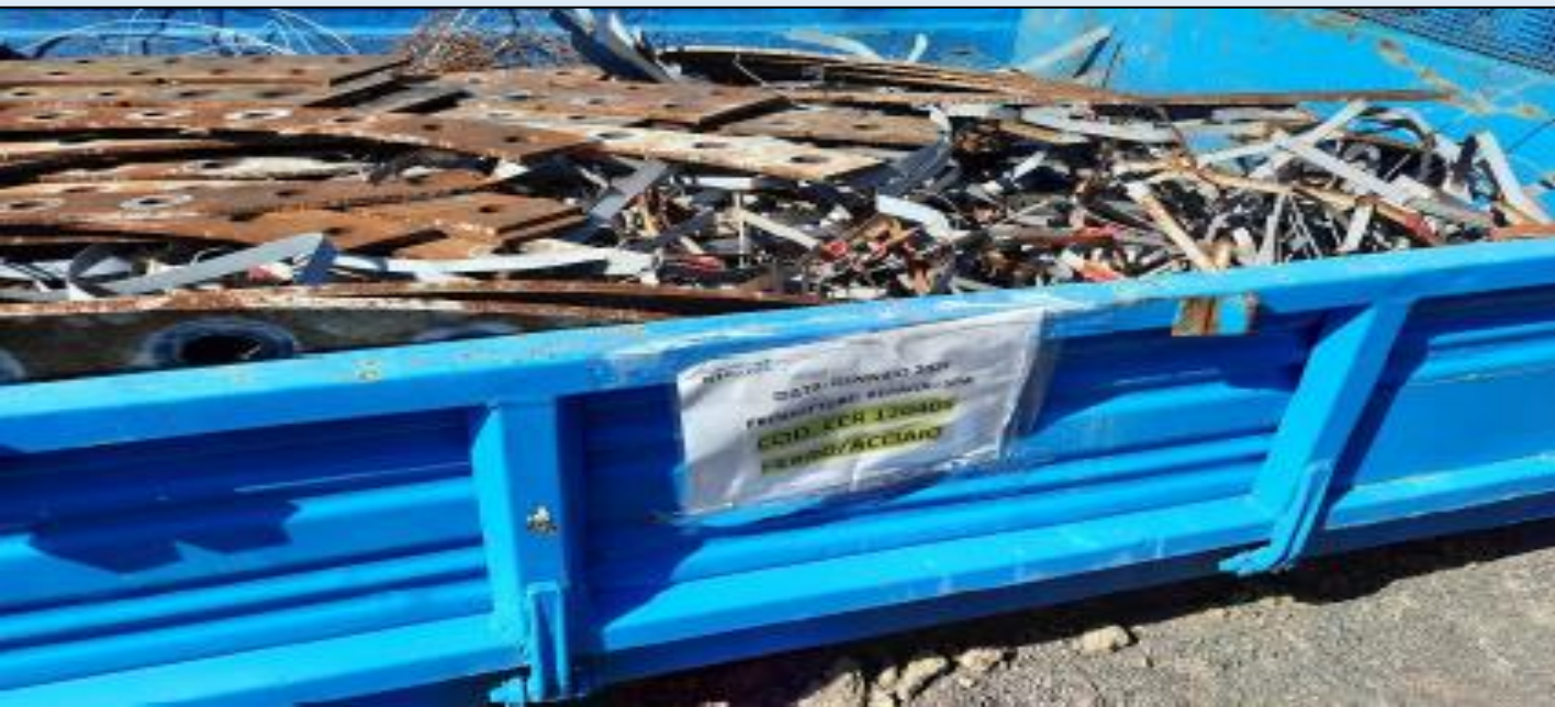
Identificazione del cassone utilizzato per il deposito dei rifiuti ferrosi
