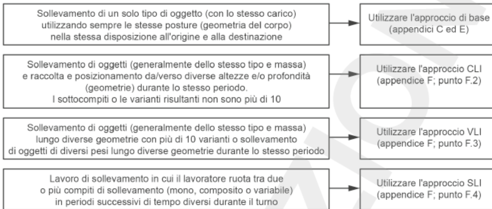
figura F.1 Diversi tipi di compiti di sollevamento e conseguenti approcci di calcolo
