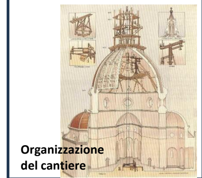
Costruzione della cupola in parallelo per permettere alle due cupole di autosostenersi
