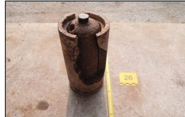
PARTE DI GRANATA CARICATA CON AGGRESSIVI CHIMICI
