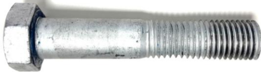
Deformazione plastica da sovrasserraggio
