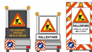
Figura 1: esempi di preavviso (carrelli con PMV) di tipo semplice o segnali rettili da utilizzare in presenza di operai al lavoro sulla carreggiata nelle fasi di installazione della segnaletica. Il pannello 9000 Fig. II 336 Art.38 Reg. va obbligatoriamente applicato contestualmente al posizionamento del carrello.
