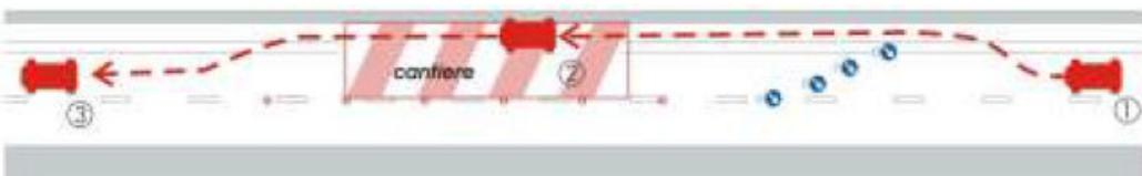
Figura 5 – Manovra di ingresso e uscita dai cantieri in caso di chiusura della prima corsia (corsia di marcia)
