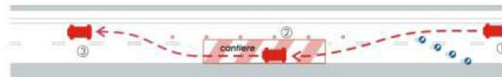
Figura 6 – Manovra di accesso e uscita dai cantieri in caso di chiusura della corsia di sorpasso
