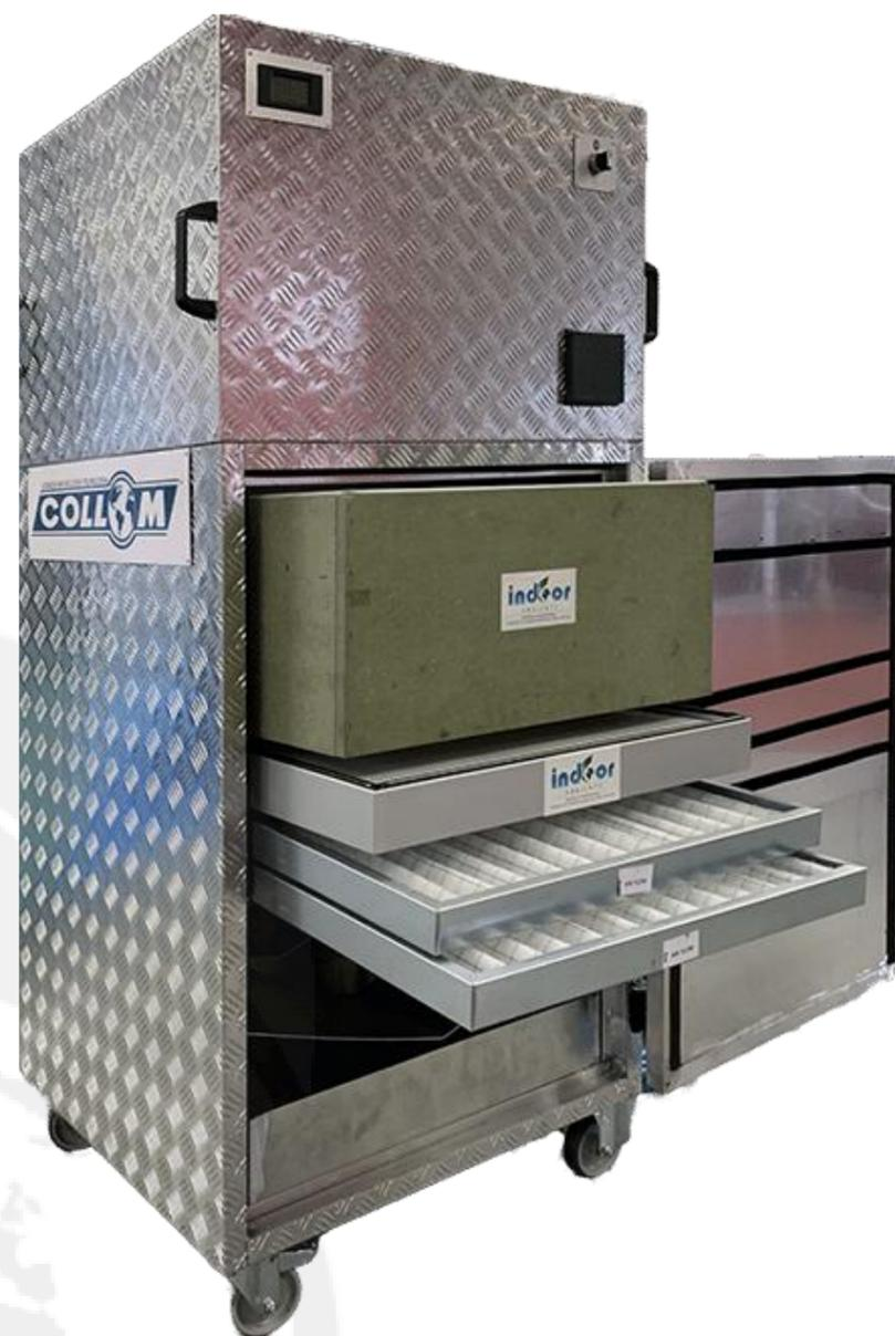
L'azione concomitante della depressione di elevata potenza crea un vero e proprio **“ciclone”** nel quale tutto il materiale staccato dalle pareti delle condotte dall'azione della sonda viene immediatamente convogliato nel vano di raccolta dell'aspiratore dotato di 4 stadi di filtrazione di cui l'ultimo con filtro assoluto.
