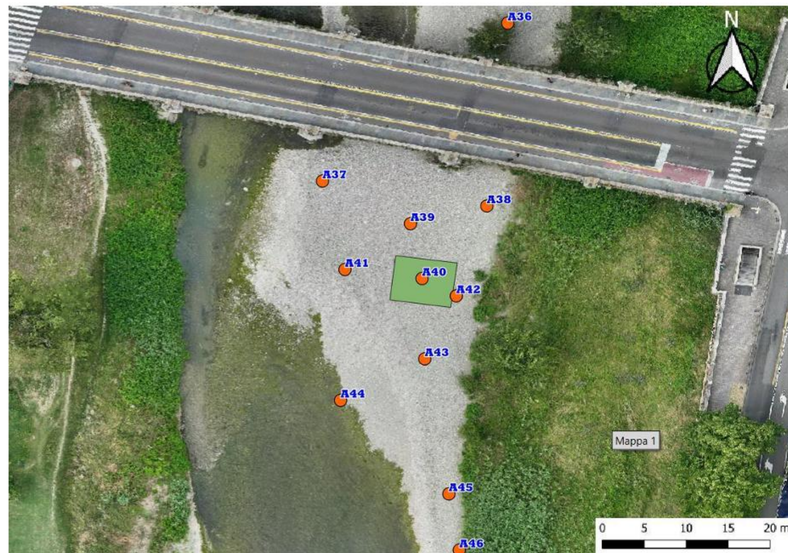
Figura 19. In verde porzione di area oggetto di approfondimento GPR (Anomalia A40)
