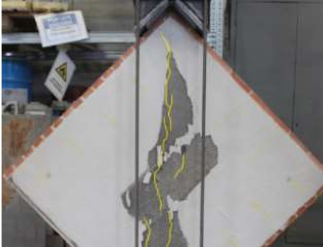
Test di compressione diagonali
