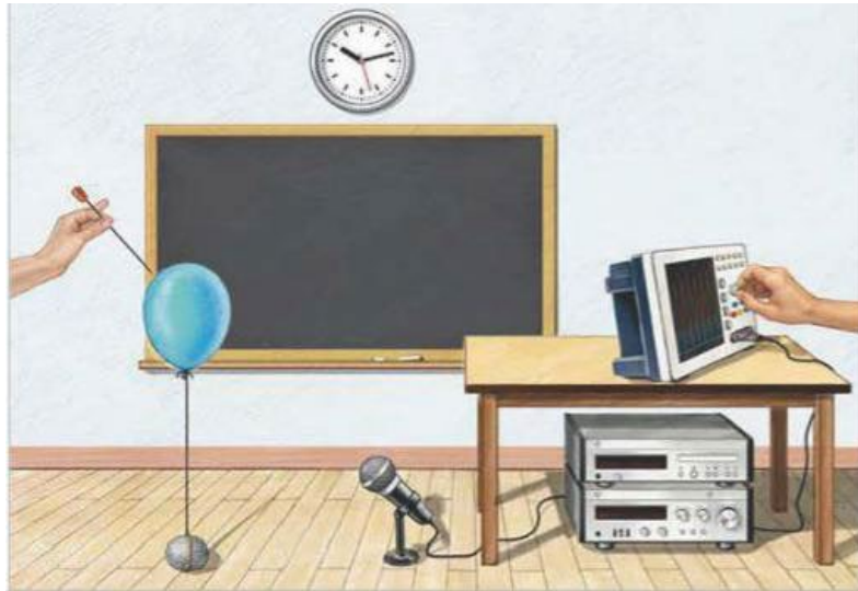
Fig. 9 — Misura con tecnica impulsiva (scoppio palloncino + oscilloscopio)
