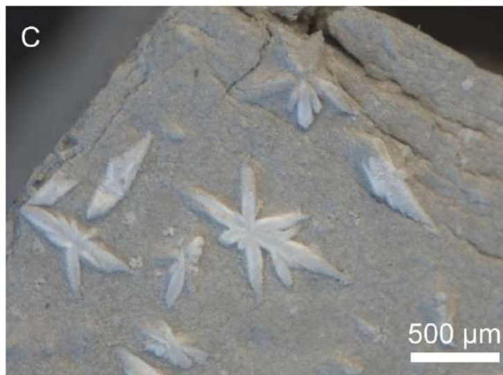
Microscopio ottico: cristalli romboidali e aggregati con una geminazione tipo "coda di rondine" tipica dei solfati di calcio (gesso o anidrite)
