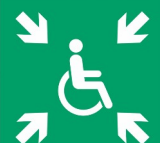
Illustrazione S.4-6: Esempio di spazio calmo (area of rescue assistance) secondo norma ISO 21542
