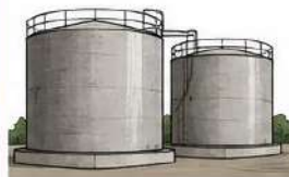
Bacini di contenimento per serbatoi di sostanze infiammabili
