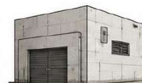
Fabbricati industriali con sfoghi di esplosione
