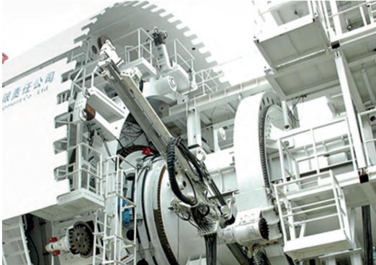
TBM con attrezzatura di perforazione per CHIODATURE
