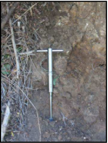
Figura 24 – Lo strumento utilizzato per le prove scissometriche in sito ("pocket vane").
